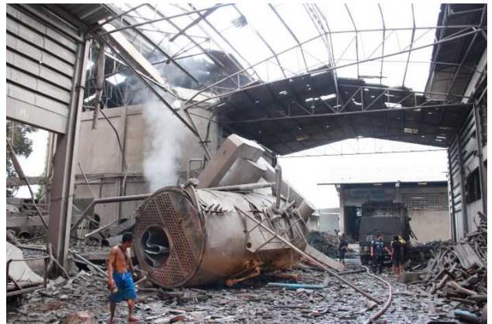
爆発後のボイラーおよび工場建屋の破損の様子
