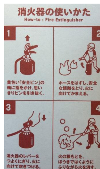
【図】消火器使用の基本ステップ
